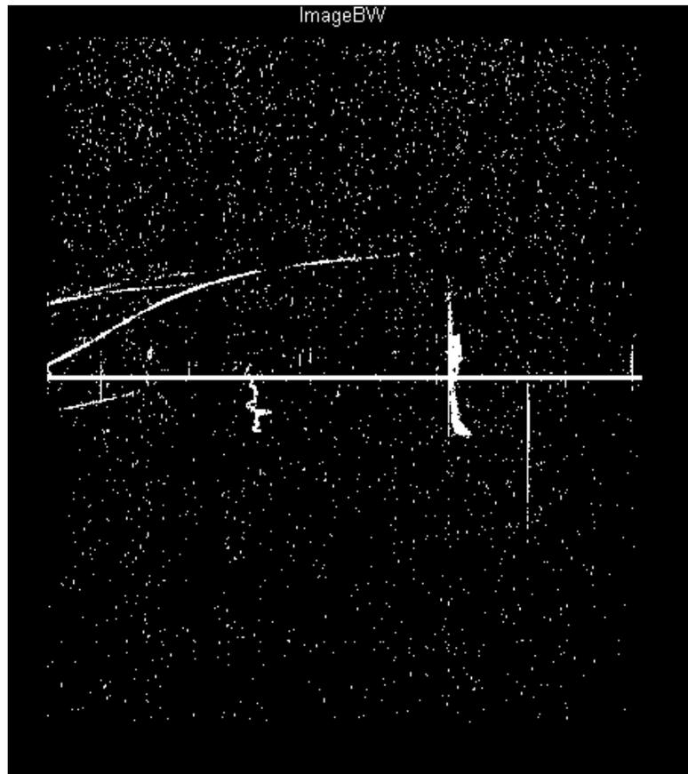
Après érosion suivant une ligne verticale de 11 éléments, l'image suivante.
